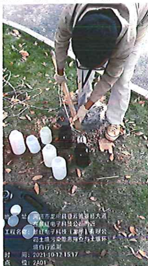
2A01 地下水取水
