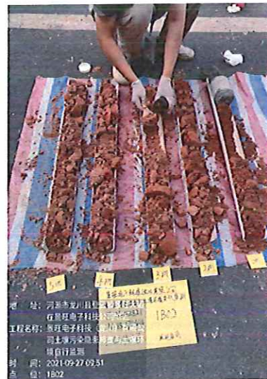
1B02 土壤取样(半挥发性样品取样)
